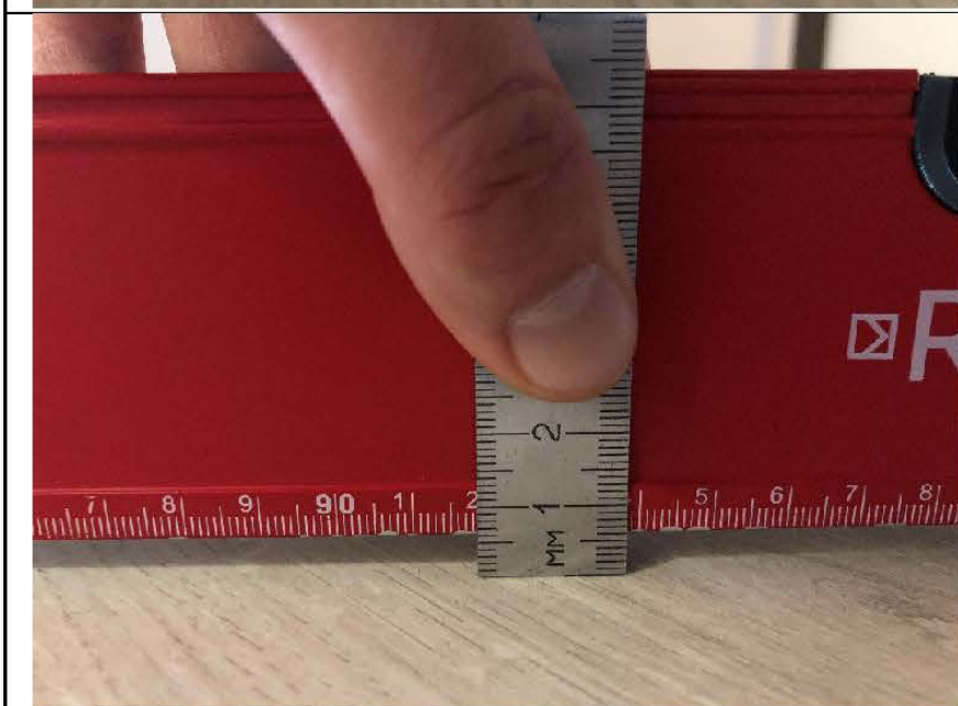
Фото №15. Измерение напольного покрытия коридора в квартире.
